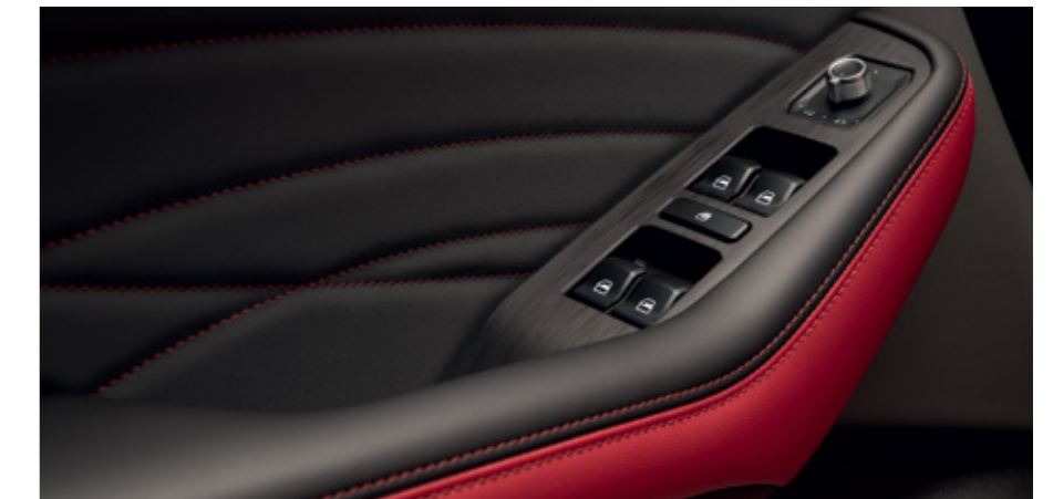
Электростеклоподъемник четырех дверей с автодоводчиком
