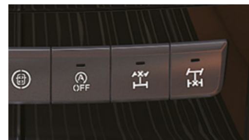
Блокировка переднего и заднего дифференциалов
